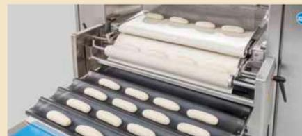
Las unidades de moldeo alargado RONDO elaboran automáticamente y con fiabilidad panecillos para bocata y minibaguettes a partir de piezas de masa.
