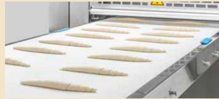
Barras saladas, con semillas y tipo brezel: la Smart Bread Line, en combinación con la Curl & More, enrolla trozos de masa triangulares, rectangulares, cuadrados, en forma trapezoidal y de rombo para dar forma a barras alargadas de pan o en forma de croissant.
