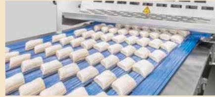
Ya sean cuadrados, en forma de diamante, triangulares o rectangulares: sus panecillos se cortan con exactitud, de forma separada y automática sobre bandejas.
