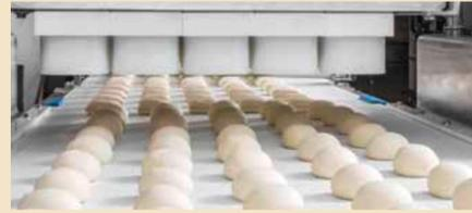
Con el RONDO Cup Rounder, el módulo automático de moldeo redondo, producirá panecillos perfectamente redondos tanto en la RONDO Smart Bread Line como en la ASTec Bread Line.
