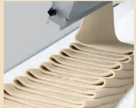
Con el equipo de laminación modular RONDO MLC automatizará la producción de productos de hojaldre y de pastelería danesa y alimentará la Starline de forma continua.
