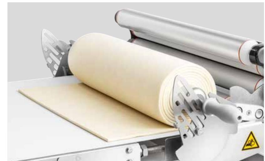
Eficiencia: Tras el laminado puede enrollar automáticamente la banda de masa (opcional)
